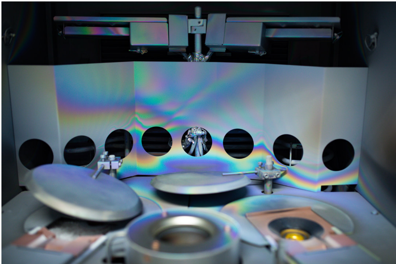
Ci-dessus : machine de dépôt sous vide BÜHLER SYRUSpro : évaporation assistée par plasma. Illustration d'interférences dans les couches, espace photonique, institut Fresnel - UMR 7249 AMU / CNRS / Centrale Marseille
