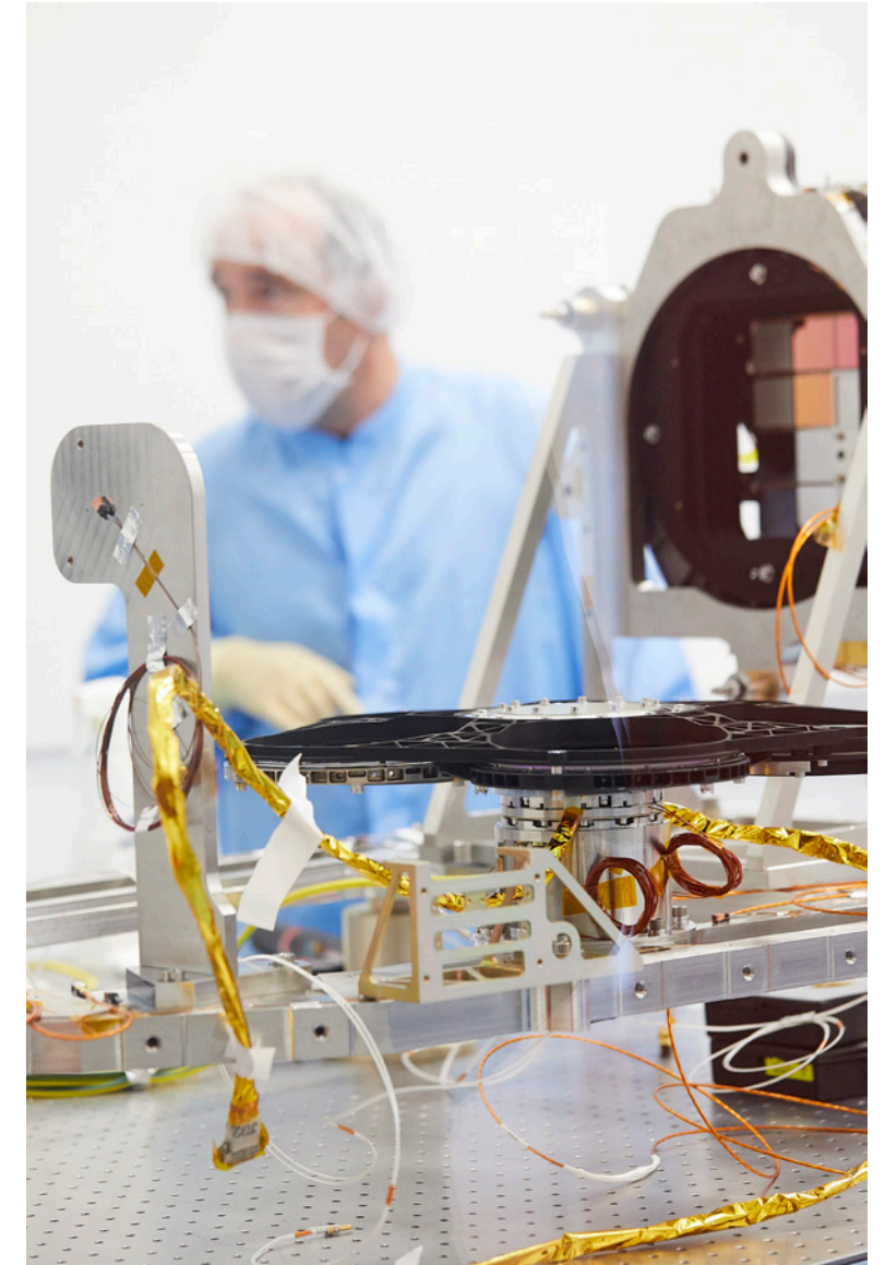
Ci-dessus : modèle de développement de l'instrument NISP en cours d'intégration - LAM UMR 7326 AMU/CNRS-INSU
